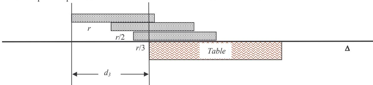
Montrer que le système est en équilibre c'est à dire que le centre d'inertie du solide constitué des trois pièces est situé à la verticale du bord de la table. (On pourra munir la droite  $\Delta$  d'un repère adapté)
